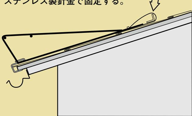
②専用取付け金具・ヴィクトリーロック、又はフェンスロック等を屋根に取り付けフェンスを固定する。
