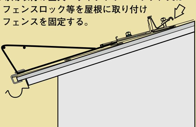
※取り付けの際、棟方向にフェンスを引張ってから取付けて下さい。
