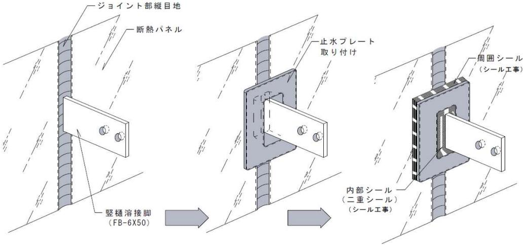
縦樋脚・ハット形止水プレート取り付け手順
