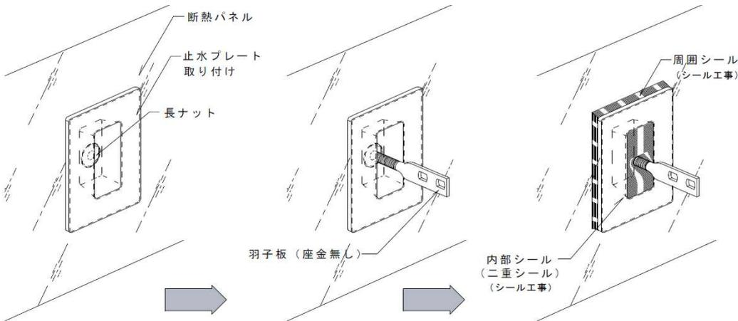
羽子板脚・ハット形止水プレート取り付け手順
